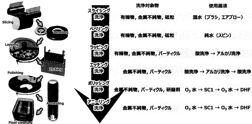
図2 Si ウェーハ製造プロセスにおける代表的な加工プロセス
