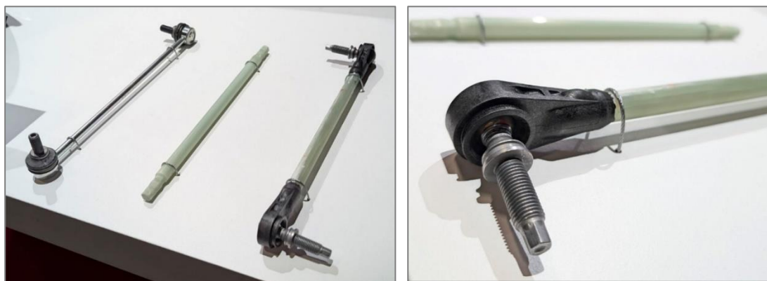
写真 5 UV 硬化プロセスで作られた GFRP 製リンクロッド
