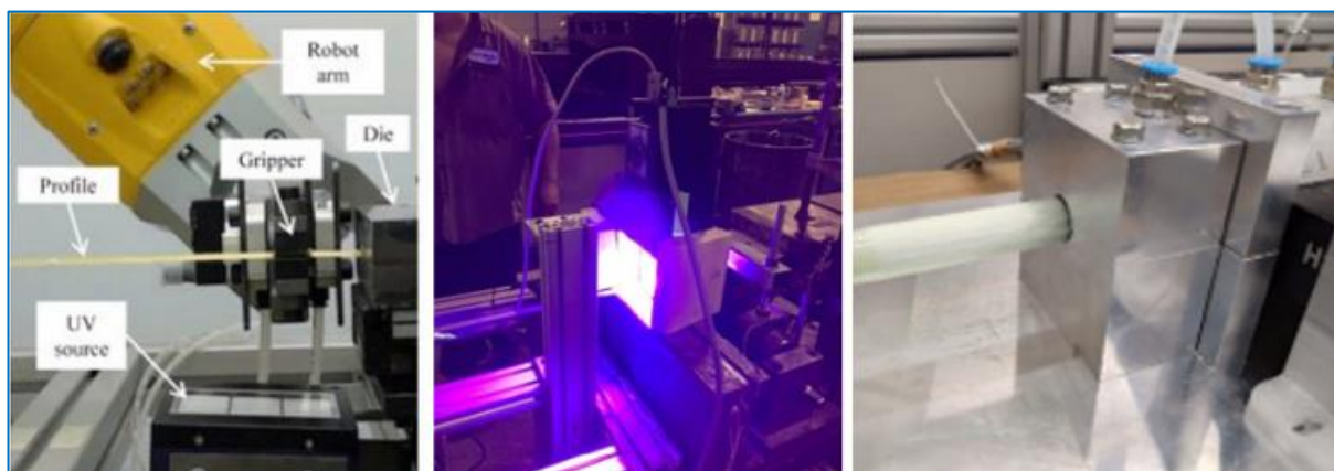
写真 6 UV 硬化でロッドを作るプルトリュージョン装置 左からダイ部分、UV 照射、冷却ゾーン (DITF)
