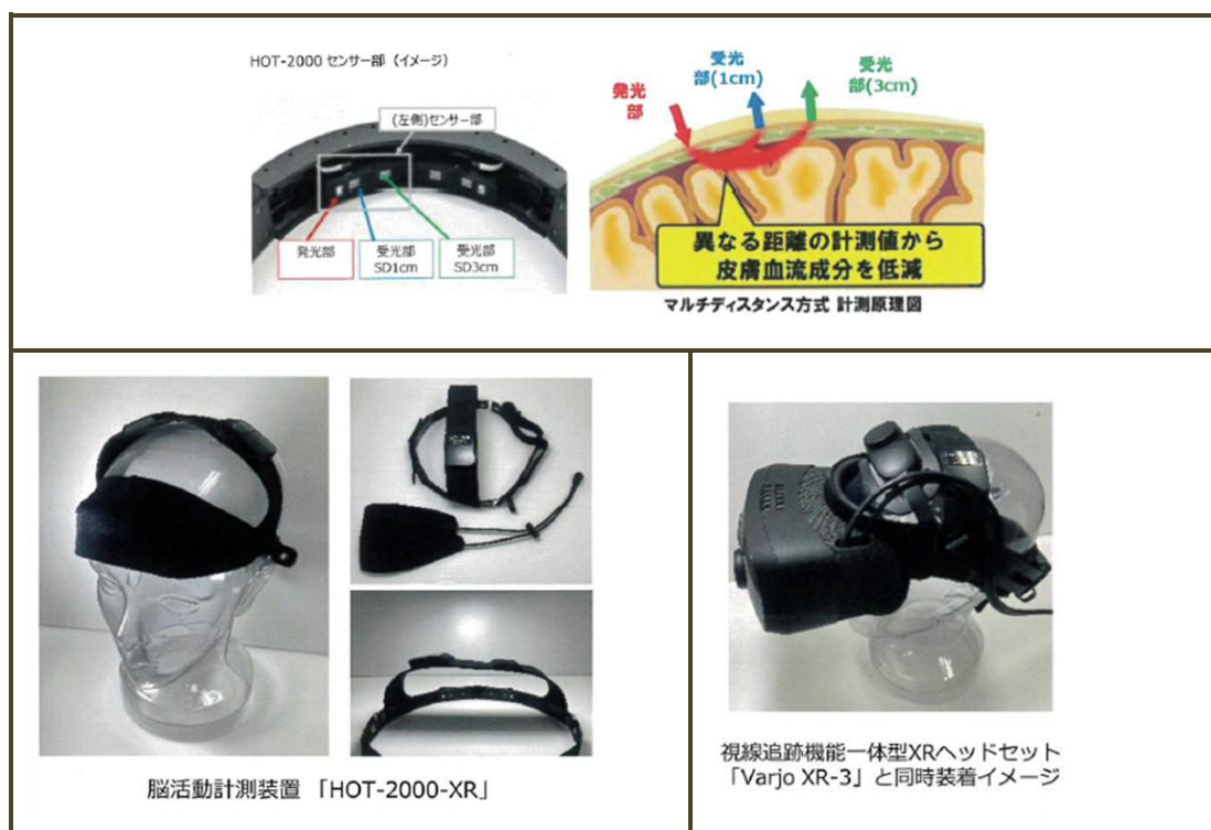
図 6-6 HOT-2000 センサー部イメージ図及び脳活動計測原理図(上段)
