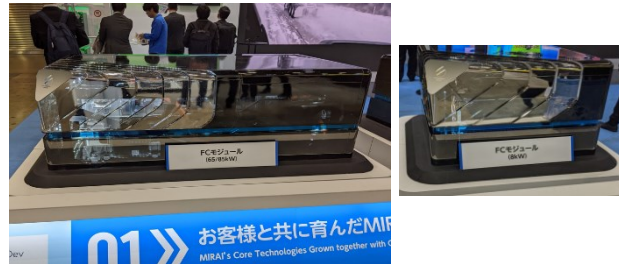
図 MIRAI への搭載用 FC モジュール：TFCM2s-F（Type II 横型）（左）と汎用型の小型モジュール（右）
