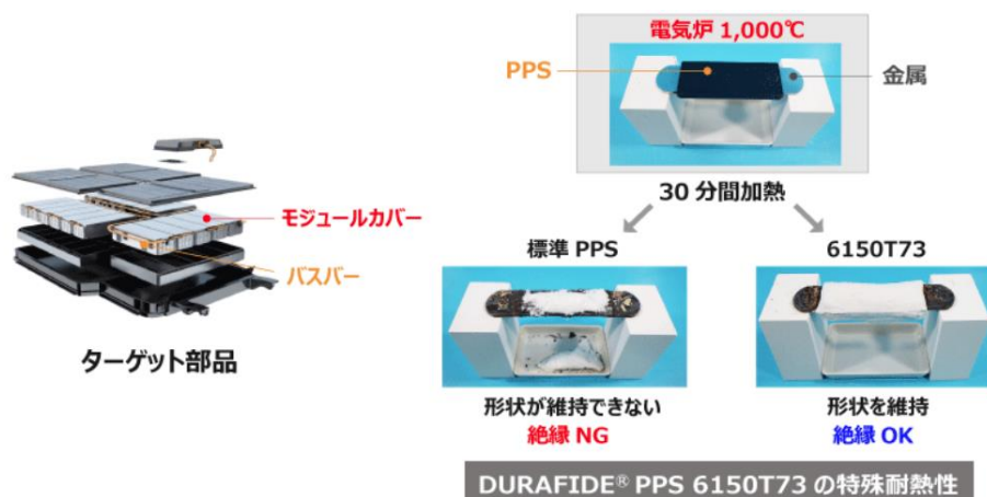
図 22 耐火バスバーに使用できる PPS(ポリプラスチックス) 27
